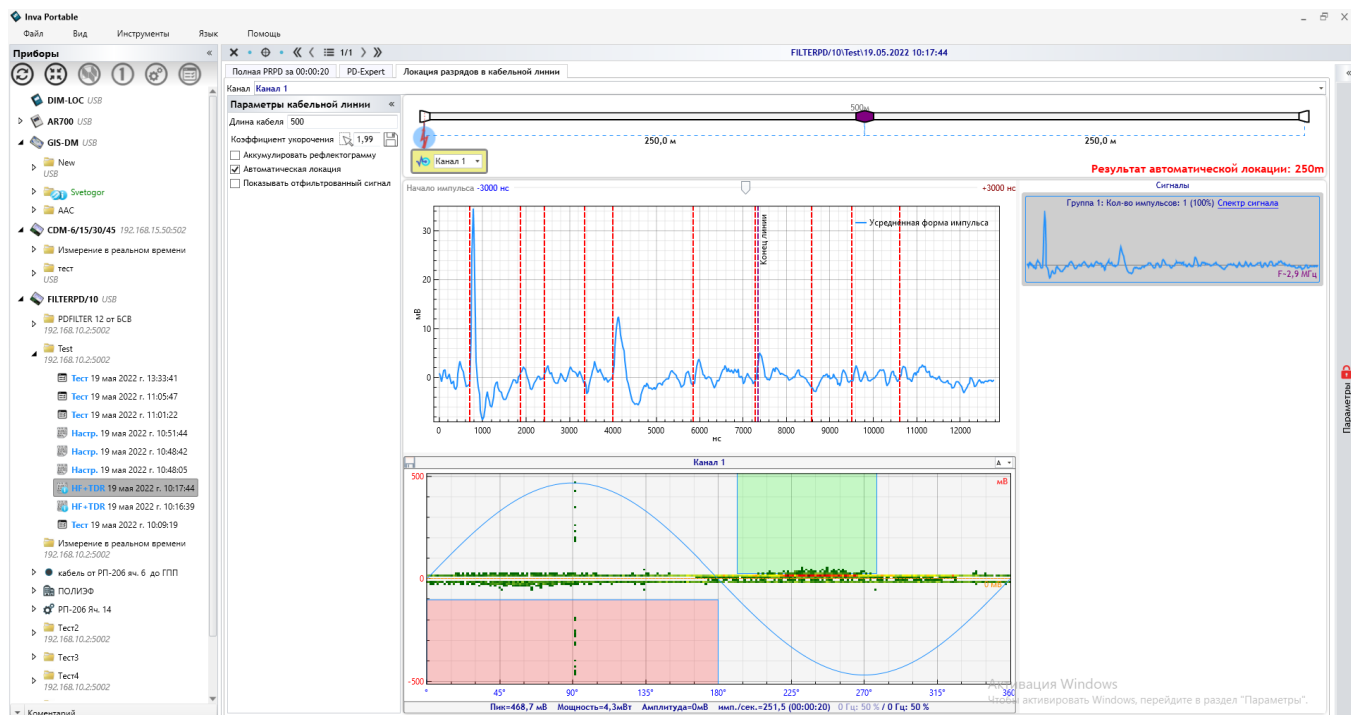
Рисунок 4.8. Результаты измерений прибором Filter-PD в диапазоне HF в кабельной линии длиной 500 м.
