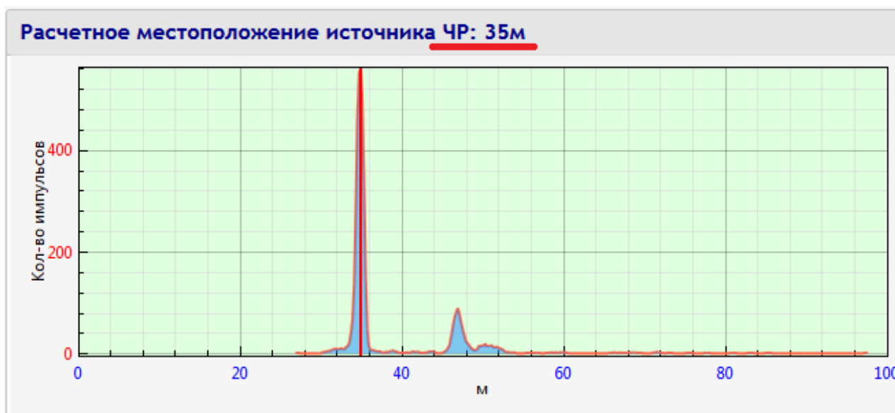
Рисунок 4.5. График количества импульсов по длине кабеля с указанием положения источника ЧР.
