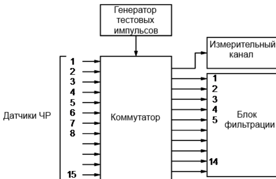
Рисунок 1. Блок-схема входных цепей модуля
