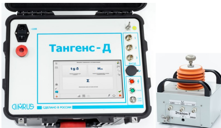
Рис. 1. Внешний вид переносного прибора Тангенс-Д и эталона тангенса марки Эталон-Т.
