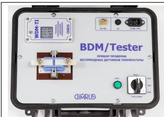
Рис. 6.3.3.1. Испытательный стенд марки BDM-Tester для настройки беспроводных датчиков температуры
