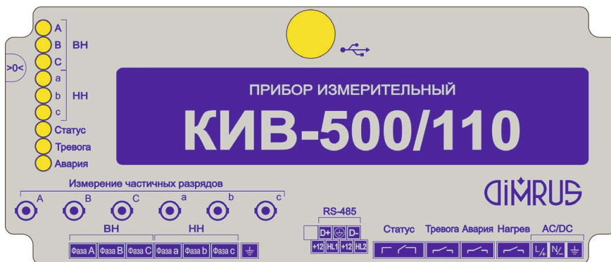
Рисунок 1.4. Внешний вид лицевой панели прибора с 6-ю контролируруемыми вводами
