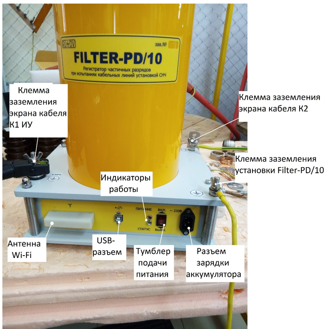
Рисунок 2.2. Регистратор и элементы управления
