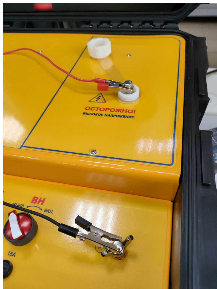
Рисунок 9.5. Подключение измерительного кабеля к системе.
