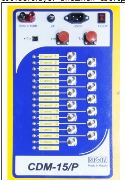
Рисунок 2.12 Клеммная панель устройства CDM-15/P
