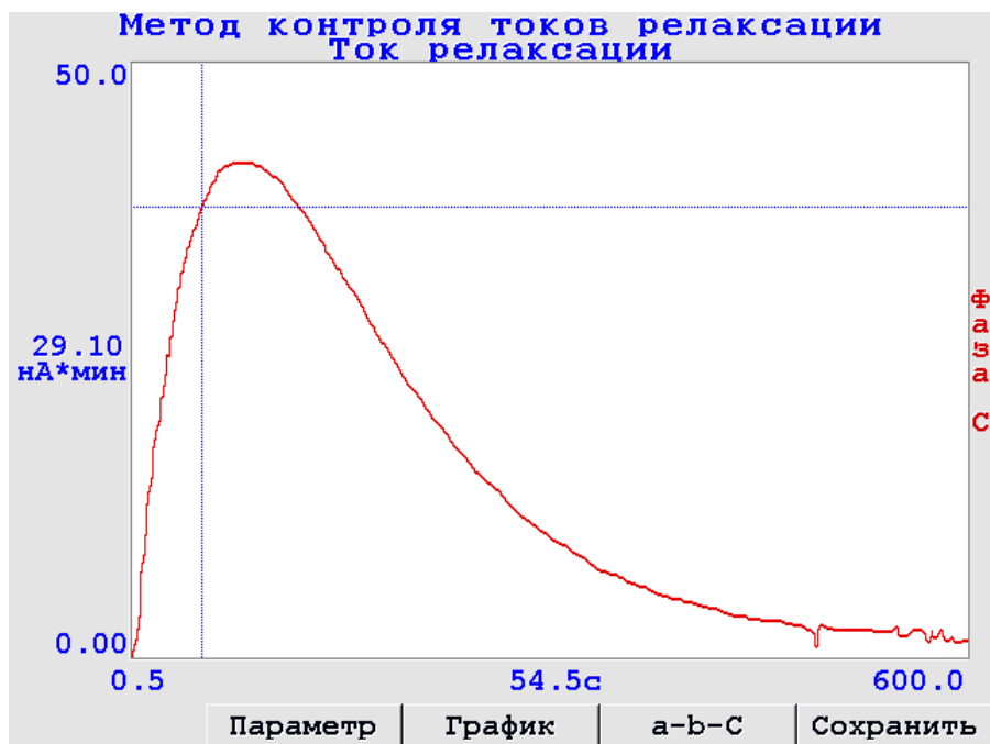
Рисунок 3.34 Кривая изменения распределенного заряда в изоляции I \cdot t = f(t) фазы А
