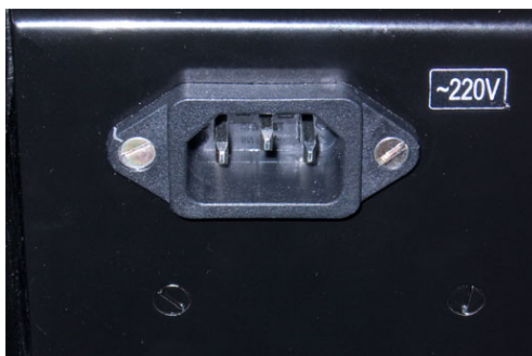
Рисунок 2.2 Разъем для зарядного кабеля АСТ
